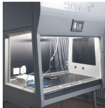
Визуализация нисходящего ламинарного воздушного потока в режиме «Хранение»
