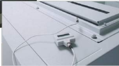
Измерение температуры выходящего воздушного потока
