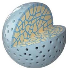
Рис.4. Схематическая диаграмма иерархической структуры слоя ядро-оболочка.
