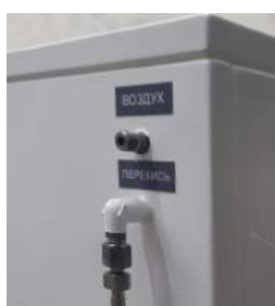
Штуцеры для подачи перекиси водорода и сжатого воздуха (на левой боковой стенке)
