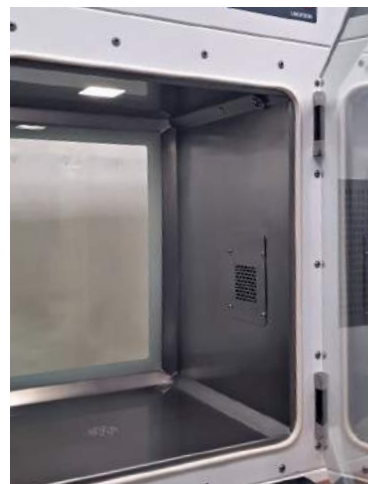
Герметичная рабочая камера из нержавеющей стали. Светодиодный светильник. Форсунки для распыления раствора перекиси водорода.
