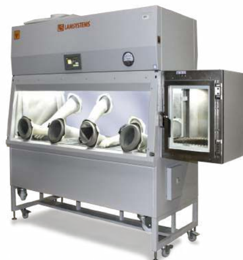
Бокс VIS-A-VIS с разноуровневым расположением перчаточных портов
